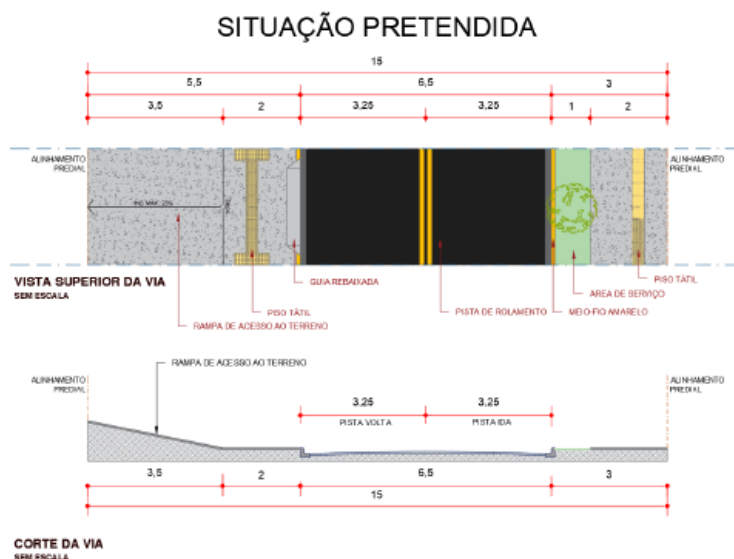
Figura 5 – Solução da calçada para acesso aos terrenos com desnível relevante Elaborado pelo autor (2026)
